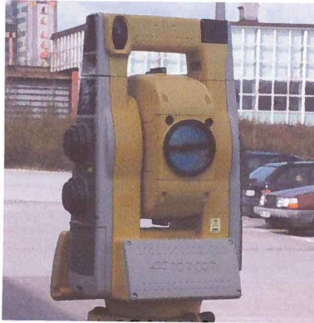
Figur 6. Robotiserad totalstation som finansierats av Byggrådet, och som används vid övningar i detaljmätning i kursen Fältundersökningsmetodik vid LTH. Totalstationen är integrerad med befintlig GNSS-utrustning.
