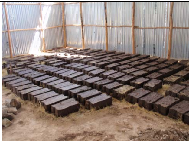
Torkning/härdning av adobeblock
