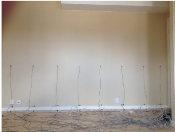
Bild 6 och 7: Visar mätningar i nyproducerade flerfamiljshus. Notera att mätningar sker både i golv, i tak och på väggen samt på anslutande golv. Detta för att identifiera transmissionsvägarna.
