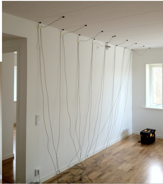
Bild 6 och 7: Visar mätningar i nyproducerade flerfamiljshus. Notera att mätningar sker både i golv, i tak och på väggen samt på anslutande golv. Detta för att identifiera transmissionsvägarna.
